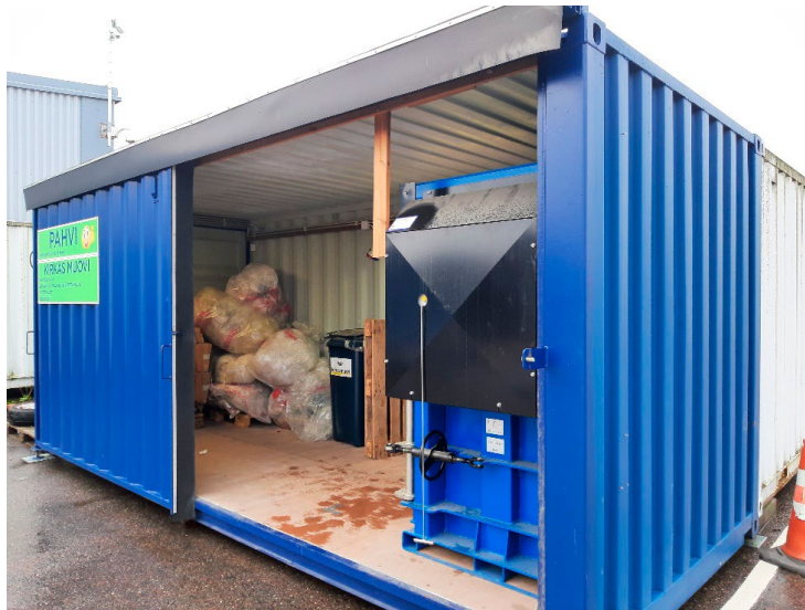
Kuva 4. Jätepaalain voidaan sijoittaa työmaalla esim. konttiin, jonne myös kerätty kalvomuovi ja valmiit paalit voidaan säilöä (kuva Helsingin kaupunki).
